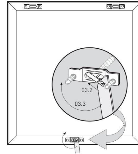
Die Spezialbeschläge (1) wie oben abgebildet mit Linsenschrauben (2) auf den Holzrahmen schrauben.
