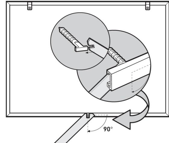
Auf der Wand die gewünschte Höhe des Bilderrahmens anreißen. Die Bohrabstände von den Außenkanten des Rahmens betragen 80 mm x 20 mm ( $\circ$  6 mm).
